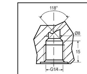
Arrivée 1 et retour 2 avec étanchéité directe (l'étanchéité avec rondelle sur lamage reste possible)
