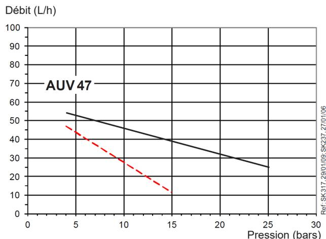
Viscosité = — 1,8 cSt Vitesse de rotation = 2850 tr/min
