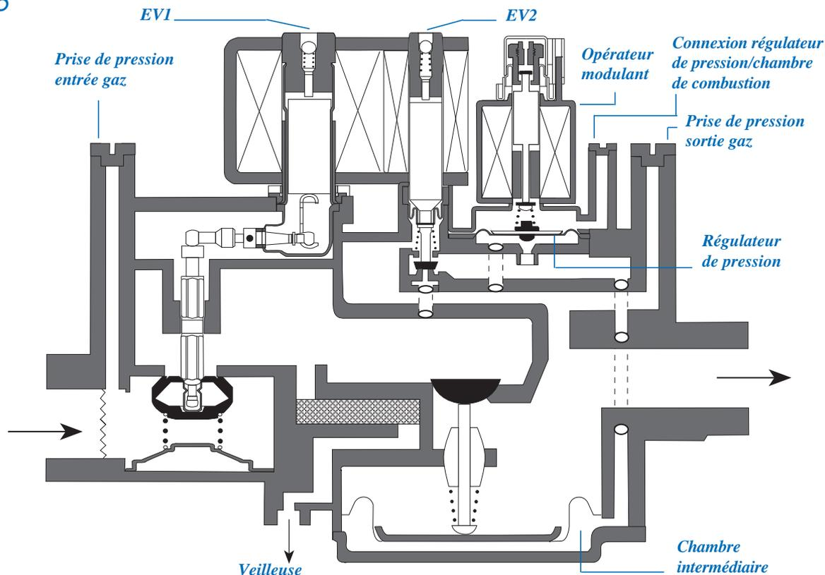
845 SIGMA dispose de deux électrovannes de sécurité pour le contrôle du débit gaz.
