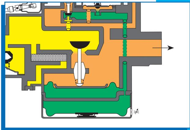
Ensuite la pression augmente rapidement et le clapet s'ouvre jusqu'à sa position nominale.
