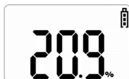
L'instrument passe en mode Mesure Gaz comme indiqué ci-dessous, lorsque l'appareil est sous tension. Le mode Mesure Gaz indique la concentration de gaz et la charge restante de la pile. La concentration en oxygène est exprimée en % alors que celle des gaz toxiques tels que H<sub>2</sub>S, CO et SO<sub>2</sub> l'est en ppm.
