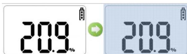
Lorsque le mode Détection Gaz indique la concentration de plusieurs gaz simultanément, le rétroéclairage est activé en appuyant brièvement sur le bouton flèche, ce qui permet à l'opérateur de lire la valeur même dans l'obscurité.
