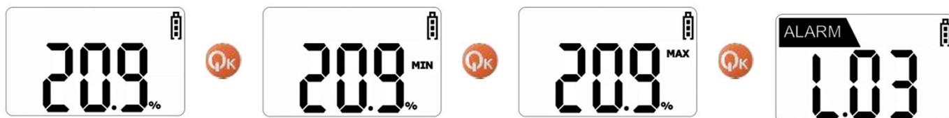
Le mode Sélection de données s'affiche lorsque l'on appuie sur le bouton flèche. Dans ce mode, une donnée est sélectionnée et son enregistrement est confirmé. En appuyant à nouveau sur le bouton on/off, la date (année, mois, jour), l'heure et l'alerte enregistrées sont confirmées. En appuyant sur le bouton flèche lorsque l'écran affiche l'année, le mois, le jour ou l'heure, le programme revient au mode de Sélection de données.
