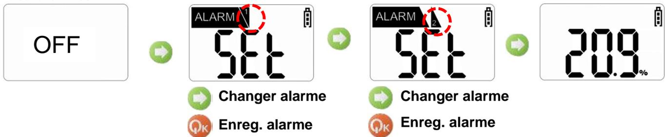
Appuyer sur le bouton on/off en mode Réglage alarme ; la valeur d'alarme est alors vérifiée. Changer la valeur de l'alarme en appuyant sur le bouton flèche et appuyer sur le bouton on/off pour enregistrer la nouvelle valeur de l'alarme ou changer de chiffre. Après le passage du dernier chiffre, appuyer sur le bouton on/off encore une fois. Le programme revient alors en mode Réglage alarme.
