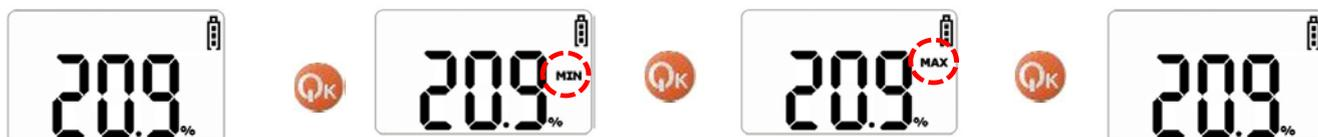
En mode Mesure Gaz, dans le cas de l'oxygène, les valeurs minimum et maximum mesurées sont affichées dans cet ordre. Dans le cas d'un gaz toxique, la valeur maximum, la valeur STEL et la valeur TWA sont affichées dans cet ordre. Le programme revient en mode Mesure lorsque le bouton on/off est pressé dans l'état affichant les valeurs crête, STEL et TWA. Si le bouton n'est pas pressé pendant plusieurs secondes, le programme revient en mode Mesure Gaz.
