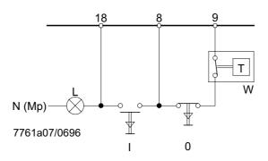
Ce circuit est utilisé lorsque l'on ne désire pas le fonctionnement entièrement automatique, pour certaines raisons (par exemple en cas de brûleurs industriels). Le démarrage se fait en actionnant le contact d'impulsion I; l'arrêt est produit par pression du contact d'arrêt 0, et dans le cas de l'actionnement du thermostat.
