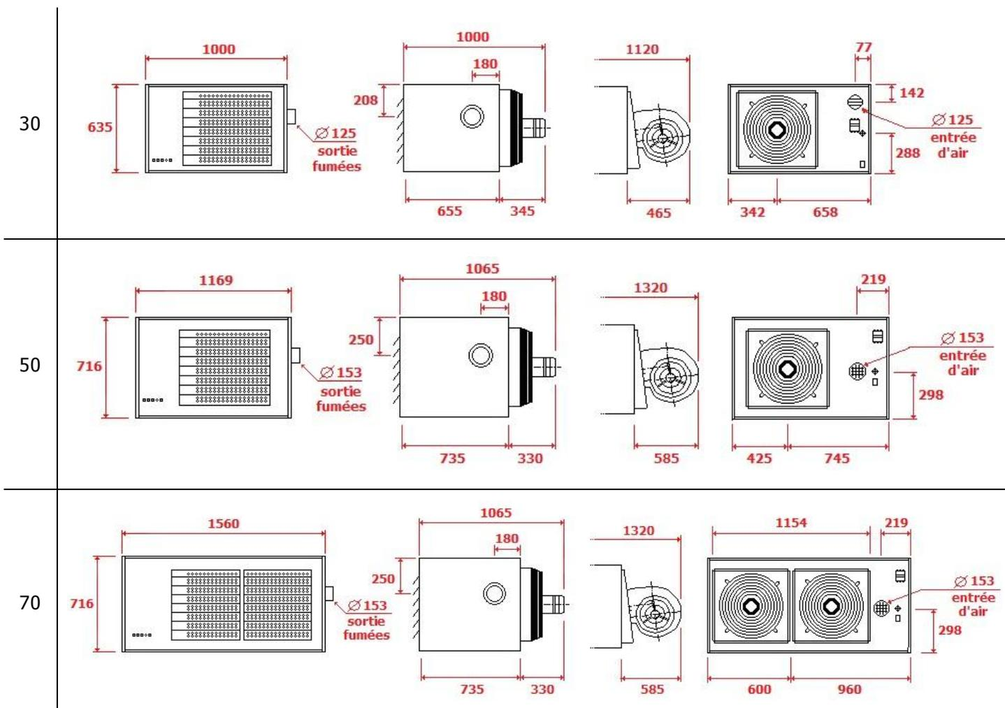
Nos appareils sont prévus pour être suspendus ou posés sur nos consoles livrées en option (2 modèles).
