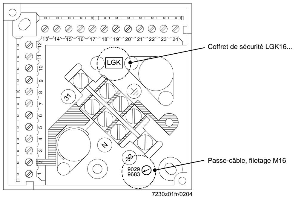
Passe-câble **Pg11** aménagé dans le socle, repéré par le numéro **9029**, voir «Encombrements».
