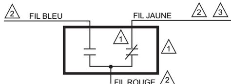
1 UTILISER DU FIL DE CLASSE 1 NEC À MOINS QUE L'ALIMENTATION ÉLECTRIQUE RESPECTE LES EXIGENCES DE LA CLASSE 2. ENRUBANNER LES FILS INUTILISÉS. S'ASSURER QUE L'APPEL DE COURANT DU CIRCUIT EXTERNE EST INFÉRIEUR AUX CARACTÉRISTIQUES NOMINALES DE L'INTERRUPTEUR.
