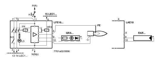
Attention : en cas d'utilisation de la sonde UV QRA..., la borne 10 doit être mise à la terre.
