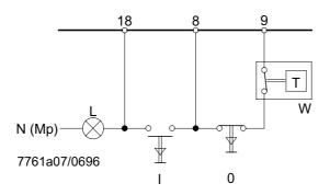
Ce circuit est utilisé lorsque l'on ne désire pas le fonctionnement entièrement automatique, pour certaines raisons (par exemple en cas de brûleurs industriels). Le démarrage se fait en actionnant le contact d'impulsion I; l'arrêt est produit par pression du contact d'arrêt 0, et dans le cas de l'actionnement du thermostat.
