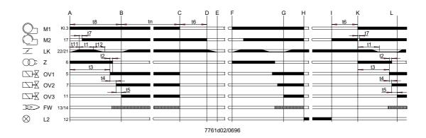
Surveillance de deux flammes ou plus de brûleurs à gaz (brûleurs monotubes) Mise en service avec préallumage court (3 s) et commande contrôlée des volets d'air. Pas de régulation de puissance. Détecteurs de flamme nécessaires : **Type LFE10...** avec sonde UV QRA... ou boucle d'ionisation
