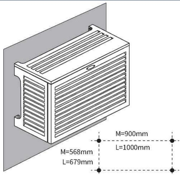
Pour un montage mural, percez le mur en vous référant aux mesures indiquées ci-dessus. Installez les chevilles dans le mur. Et positionnez le cache-climatisation comme sur le schéma.
