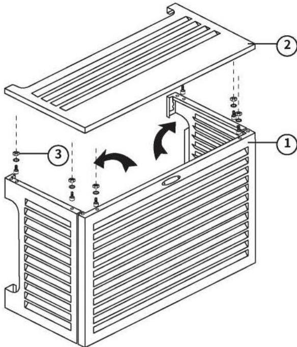
Dépliez la partie principale du cache climatisation ① puis utilisez les boulons ③ pour fixer le couvercle (partie haute) avec les parties latérales.
