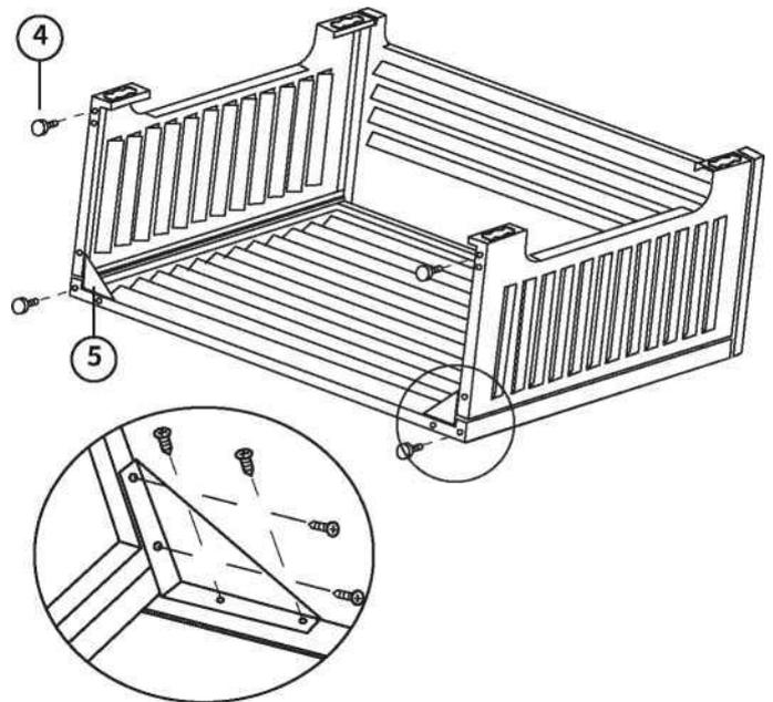
Pour l'installer au sol, fixez les pieds ④ sous le cache ① puis fixez les pièces triangulaires ⑤ sur l'avant et les parties latérales du cache climatisation ①.
