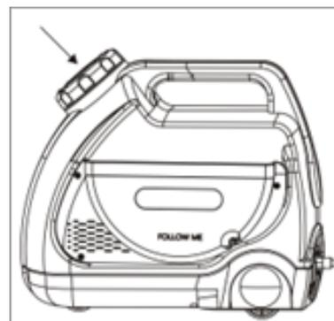
Tourner le bouchon dans le sens inverse des aiguilles d'une montre pour refermer le réservoir.
