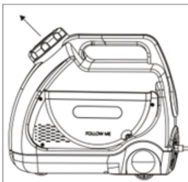
Tourner le bouchon dans le sens inverse des aiguilles d'une montre pour ouvrir le réservoir.
