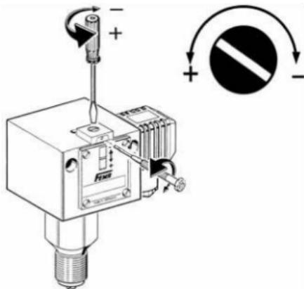
Fig. 4. Réglage de la pression de commutation
