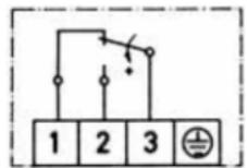
Fig. 1. Schéma du raccordement
