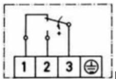
Fig. 13. Schéma du raccordement Contacts or SPDT
